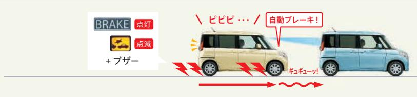
作動したときの速度が約5km/h～約50km/h未満(歩行者の場合は約5km/h～約30km/h未満)であれば、衝突を回避できる場合があります。周囲の環境や対象物の動きなどによっては、警報のみでブレーキが作動しない場合があります。また、警報と同時に自動ブレーキが作動する場合があります。
