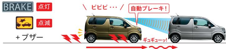
作動したときの速度が約5km/h～約50km/h未満(歩行者の場合は約5km/h～約30km/h未満)であれば、衝突を回避できる場合があります。周囲の環境や対象物の動きなどによっては、警報のみでブレーキが作動しない場合があります。また、警報と同時に自動ブレーキが作動する場合があります。
