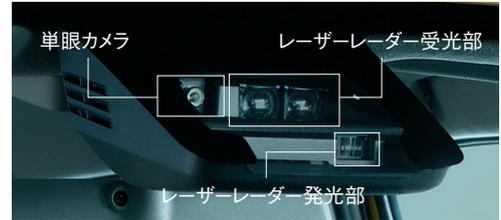
単眼カメラとレーザーレーダーがワイパー作動域にあるため、雨天時にも作動します。
