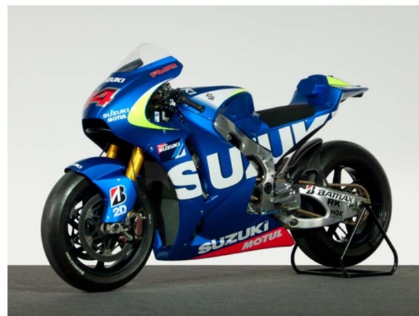
モトGP開発車両 1000cc並列四気筒GPLレーサー
