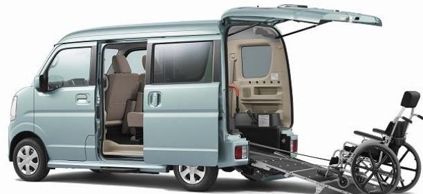
エブリイワゴン 車いす移動車 電動オートステップ装着車
