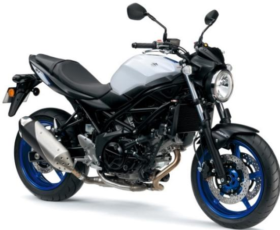
**新型「SV650」**は、既存の645cm<sup>3</sup> V型2気筒(Vツイン)エンジンをベースに、新排出ガス規制「ユーロ4」(欧州仕様車)を満たしながら出力と燃費性能を高め、軽量でコンパクトな車体に搭載したロードスポーツバイクである。車両の細部にわたる見直しを行い、既存エンジン搭載の「グラディウス」と比較して8kg(ABS仕様車)の軽量化を実現したスリムで軽量な車体は、Vツインエンジンの力強さを引き立てるとともに、高い操縦性に貢献する。エンジン内にはピストンのスカート部にスズめっきと樹脂コートを施すことで、メカニカルロスを低減し燃焼効率を高めた。
