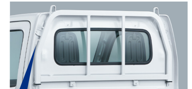
アンクルポストフック アンクルポスト[ガードバー付] ロープを通して長尺物の積荷をしっかりと固定 できます。*スーパーキャリアは形状が異なります。
