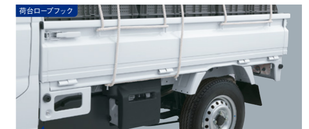
アンクルポストフック アンクルポスト[ガードバー付] ロープを通して長尺物の積荷をしっかりと固定 できます。*スーパーキャリアは形状が異なります。
