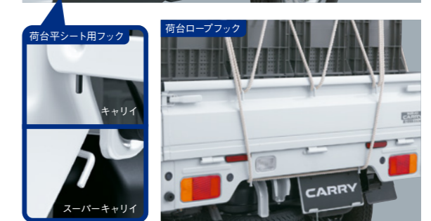
荷台平シート用フック/荷台ロープフック 便利な平シート用フックを採用することで、シートがかけを容易にして います。また、豊富なロープフックにより、積荷にあわせて多彩な ロープがけができます。*スーパーキャリアの荷台平シート用フックは、運転席側と 助手席側で形状が異なります。(写真は助手席側) Photo:KCエアコン・パワステ ボディーカラーはホワイト(26U)
