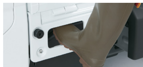
荷台ステップ(運転席側、助手席側) 開口幅が大きく、長靴でも足がかけやすいので便利です。 *スーパーキャリアは運転席側だけの設定です。
