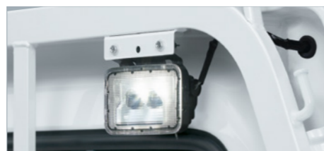
LED荷台作業灯(KX、KCエアコン・パワステ農繁、X) 荷台を明るく照らして、夜間の作業をサポートします。
