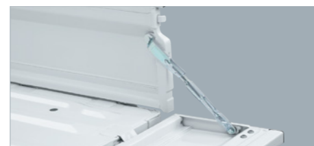
リヤゲートチェーン(KX、KCエアコン・パワステ農繁、X) リヤゲートを水平に保ち、長尺物の積み降ろしをサポートします。
