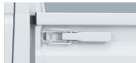
大型ゲートハンドル 頑丈で握りやすいハンドル形状により、サイドゲート、 リヤゲートをがっちりロックします。
