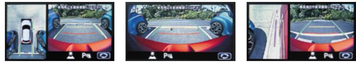
1 トップ映像+前方/後方映像 2 前方/後方ワイド映像 3 サイド映像+前方/後方映像
