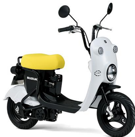
アシスト自転車の電動ユニットを使用した 近距離モビリティ「e-choinori (イーチョイノリ)」
