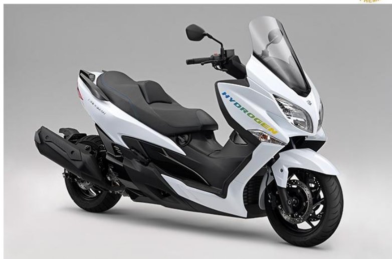
<二輪技術展示車> 水素エンジンバーグマン (試験車両)
