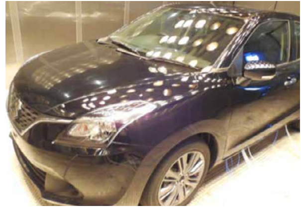
恒温恒湿槽での車室内VOC測定の様子(パレーノ)
