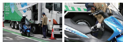
浜松水素ステーション(移動式)での水素充填(2017年3月から実際の運用開始)
