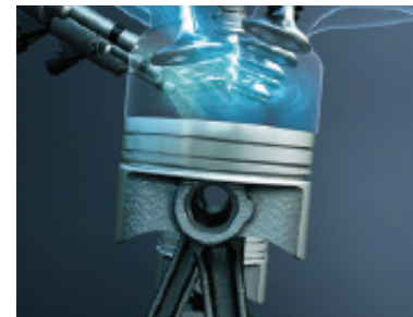
シリンダー内直接噴射イメージ
