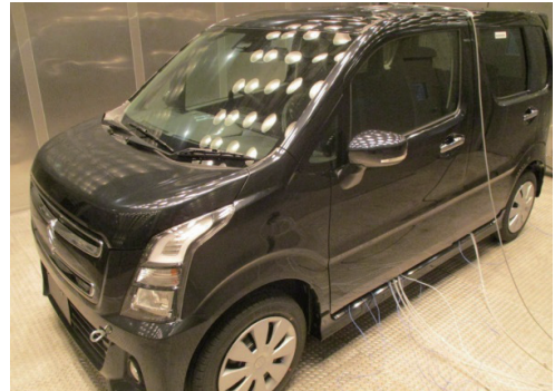
ワゴンRスティングレーの車室内VOC測定の様子
