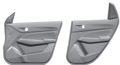
フロント、リヤドアトリム 樹脂部品の薄肉化
