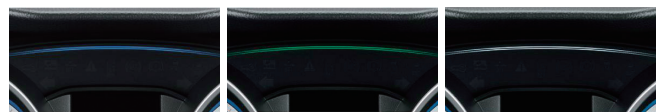
通常運転の状態 ブルー 燃費効率が良い状態 グリーン 減速エネルギー回生時 ホワイト
