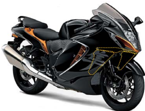
リサイクル樹脂材料の使用箇所 (例:新型「Hayabusa」)
