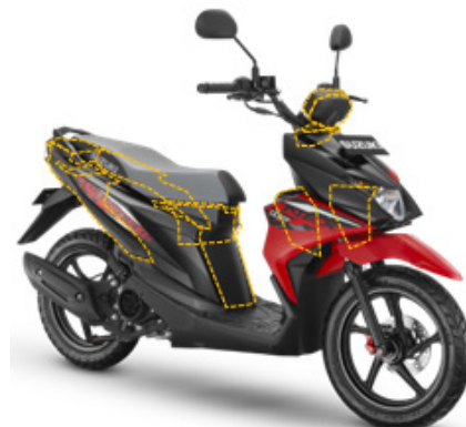
リサイクル樹脂材料の使用箇所 (例:ネックス クロスオーバー)
