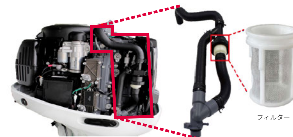
マイクロプラスチック回収装置を取り付けた船外機
