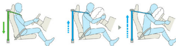
フロント・リヤ ELR 3 点式シートベルト作動時説明画像
