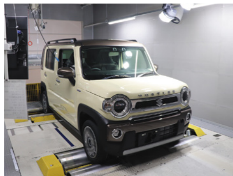
完成検査 Final Inspection
