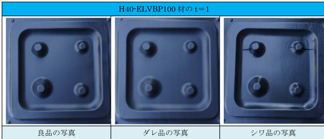
図 2-23.良品、ダレ品、シワ品の写真 (H40-ELVBP100 材の t=1)
