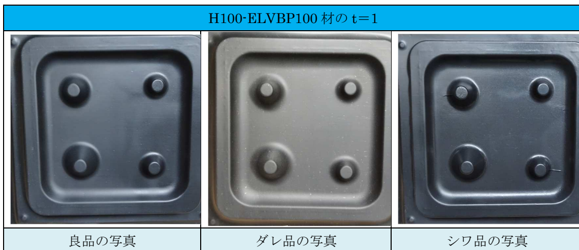
図 2-24.良品、ダレ品、シワ品の写真 (H100-ELVBP100 材の t=1)
