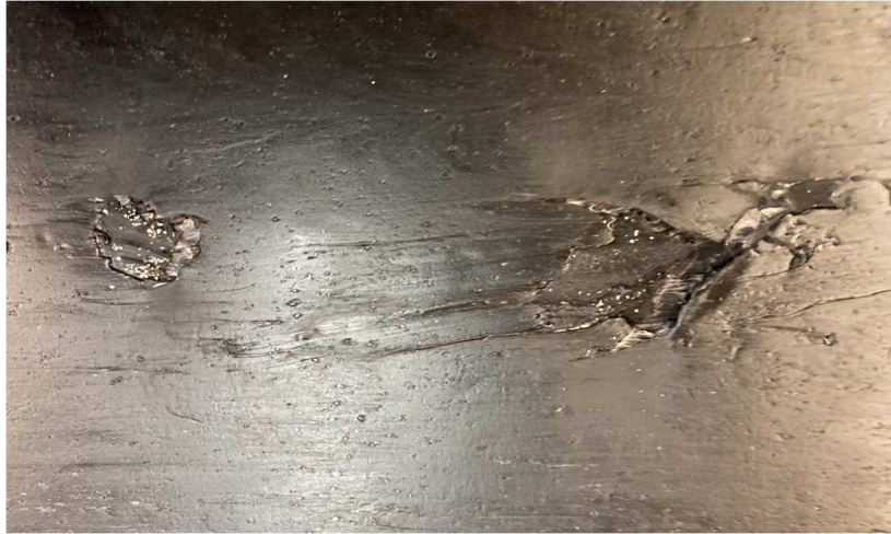
図 2-6. t=3 の外観不良例 (H40-ELVBP100 材)
