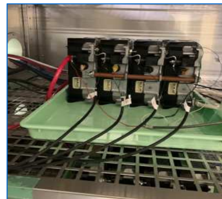
図4 直列接続サイクル試験
