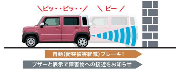
\*自動(衝突被害軽減)ブレーキ機能による車両停車後は、クリープ現象により後退しますので、必ずブレーキペダルを踏んでください。
