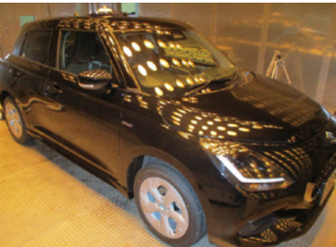
新型スイフト 車室内VOC測定の様子
