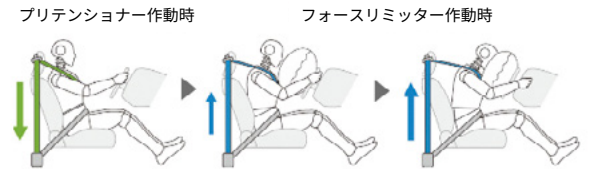
フロント・リヤELR 3点式シートベルト作動時説明画像
