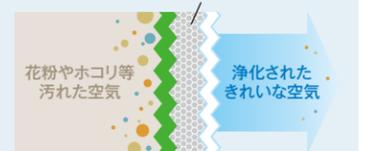
2.5μm粒子を約90%、1.0μm粒子を約65%、0.3μm粒子を約30%キャッチ。 ※2 ※3
