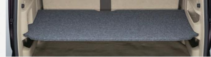
車両に標準装備のラゲッジボードステー(上下2箇所)に専用トノボードが取り付けできます。
