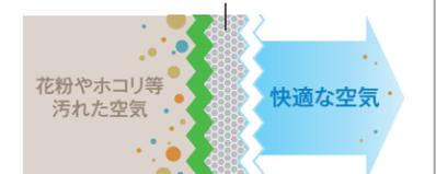
2.5μm粒子を約90%、1.0μm粒子を約65%、0.3μm粒子を約30%キャッチ。
