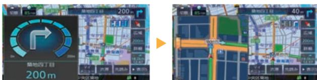
ポイントに近づくと残距離が右から減り、直前になるとイラスト表示に切り替わります。 ※一般道は約350m手前から、高速道路は約1.1km手前から表示されます。
