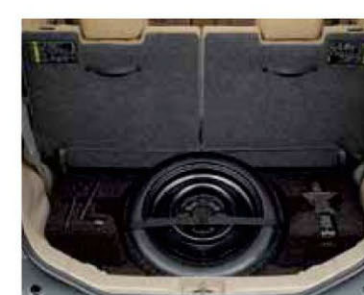
①応急用スペアタイヤを固定した状態
