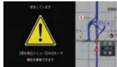
高速道路の入口、ジャンクション、インターチェンジ、SA・PAの本線合流部での逆走を検知し、画面表示と音声で警告します。
