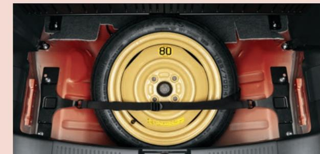
①応急用スペアタイヤを収納した状態 ※写真は4WD車用
