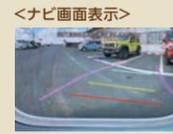
車庫入れなどの後退運転時に、ステアリング操作と連動して参考になるガイド線を画面に表示するので、感覚がつかみやすくなります。
