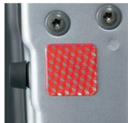
夜間ドアを開けたとき、後続車のヘッドライトを反射します。
