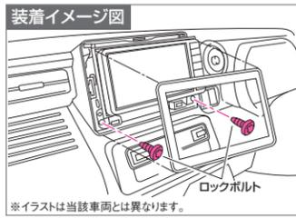
カーナビやオーディオの取付用ビスをロックボルトに交換するだけで、専用キー以外での取り外しを困難にします。
