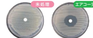
※カンテン培地に枯草菌を繁殖させ、未処理タブレットと、エアコーデを含ませたタブレットを中心に置く。抗菌作用があれば、タブレットの回りに、阻止円ができる。(製造元調べ)
