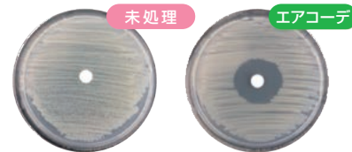
※カンテン培地に枯草菌を繁殖させ、未処理タブリットと、エアコーデを含ませたタブリットを中心に置く。抗菌作用があれば、タブリットの回りに、阻止円ができる。(製造元調べ)
