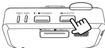
しばらく押したままにしていると記録 LED(青)が点滅しアップデートを開始します。アップデートが完了すると記録 LED(青)が消灯し、本機が自動で再起動します。
