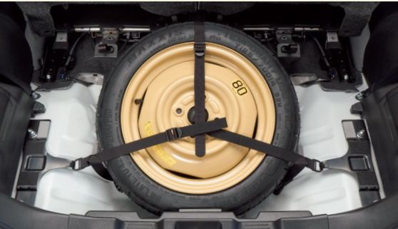
①応急用スペアタイヤを固定した状態 ※写真は4WD専用 ※タイヤ交換には139 ジャッキ&レンチセットが必要です。 ※212.当キットには、スペアタイヤは含まれておりません。別途213.スペアタイヤセットをお買い求めください。 ※44.リラックスクッション、74.ラゲッジユーティリティネット、75.ラゲッジマット(バンパーカバー付)、76.ラゲッジマット(ソフトトレー)、77.ラゲッジマット(シート背裏あり)、201.シートバックポケット(フロアボックス付)と同時に装着はできません。 ※当キット装着時は、荷室の床面が約150mm上がり、後席シートのスライドができなくなります。リクライニングは可能ですが、フラットにできません。標準装備のパンク修理キット、ラゲッジアンダーボックスは荷室フロア下に収納できなくなります。 ※自転車のサイズや形状によっては積載できない場合があります。
