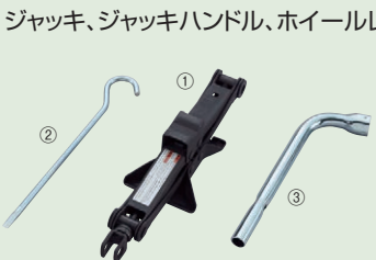
ジャッキ、ジャッキハンドル、ホイールレンチのセット パンク時にスペアタイヤへ交換する際は、ジャッキ&レンチセットが必要です。必ずジャッキ&レンチセットをお買い求めください。 139. ジャッキ&レンチセット [G][X][GS][XS][XSTURBO][XZ][XZTURBO] ①ジャッキ (89910-74P01) ②ジャッキハンドル (89931-64P00) ③ホイールレンチ (89961-82M00) E9M5 ①+②+③ 本体価格合計 5,995円
