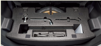
②中ブタをした状態 212. スペアタイヤ固定キット [G][X][GS][XS][XSTURBO][XZ][XZTURBO] ①F9HC(99157-53U20) 2WD車用 本体価格 46,200円 [1.0h] ②F9HD(99157-53U10) 4WD車用 本体価格 48,400円 [1.2h]
