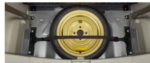
① 応急用スペアタイヤを固定した状態 ※写真は2WD車用
