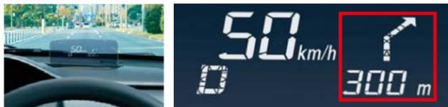
全方位モニター用カメラパッケージ(メーカーオプション)装着車に、全方位モニター対応ナビゲーションを装着すれば、ヘッドアップディスプレイ内に交差点案内が表示されます。ドライバーの視線移動や焦点の調節を減らし、安全運転に貢献します。
