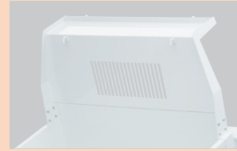
荷台側鳥居(パネル型)のガードフレームが、荷台の積載物からキャビンを守ります。
