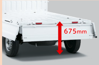
積みやすく降ろしやすい、高さを抑えた低床設計の荷台により、作業の負担を軽減します。
