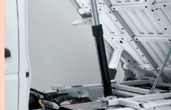
シンプルな構造の直押し式ダンプ機構。ダンプ下降時のショックをやわらかく吸収するクッション付シリンダーを採用しています。
