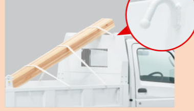
長尺の積荷をしっかりと受け止める鳥居フックを装備し、安定した輸送を可能にします。
