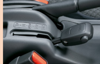
平坦な砂利道やあぜ道などでは4H(4WD高速)を、起伏の激しい荒れた道などでは4L(4WD低速)をレバー操作で切り替えることができます。 *4Hと4Lの切り替えは、必ず停車して行ってください。
