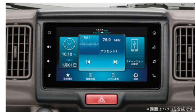
7インチのディスプレイを備えたカーオーディオ。ラジオやBluetooth®接続による音楽再生・ハンズフリー通話、バックアイカメラ表示など多くの機能を搭載。スマートフォン連携によって対応する地図アプリの表示も可能です。
