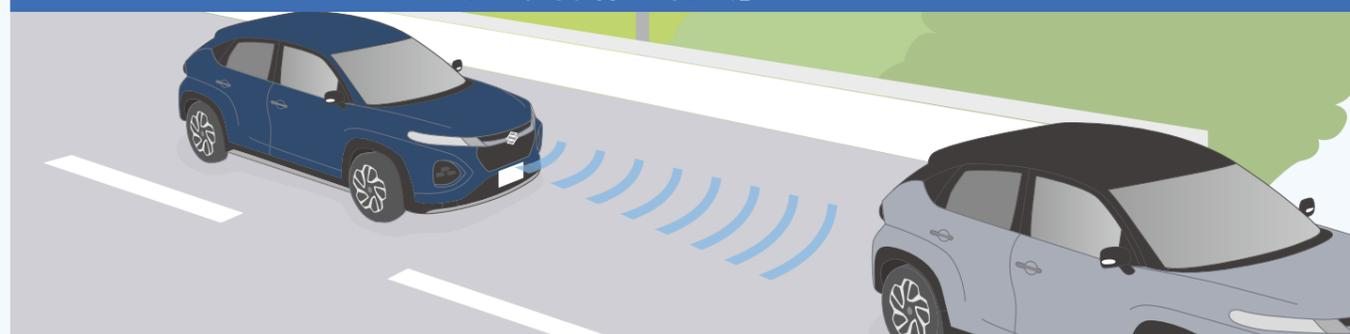
高速道路や自動車専用道路を走行中、設定した速度での走行や、適切な車間距離を保ちながら先行車を追従することで、運転操作の負担を軽減します。
