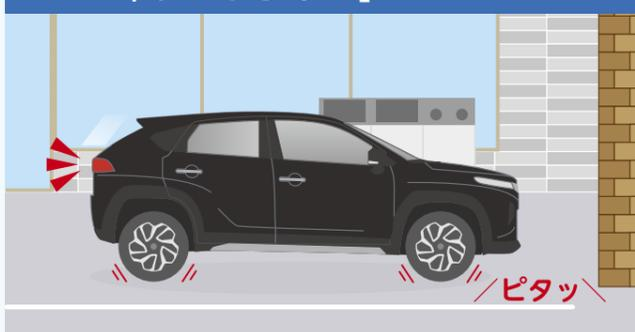
駐車時などで障害物を検知し、低速時の走行をサポートします。
