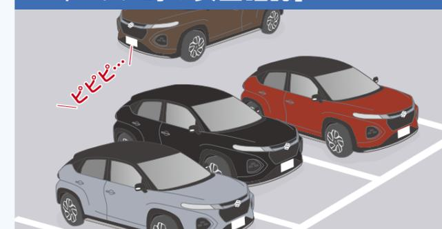
駐車場で後退時、後方左右より接近するクルマを検知。駐車場から後方発進をサポートします。
