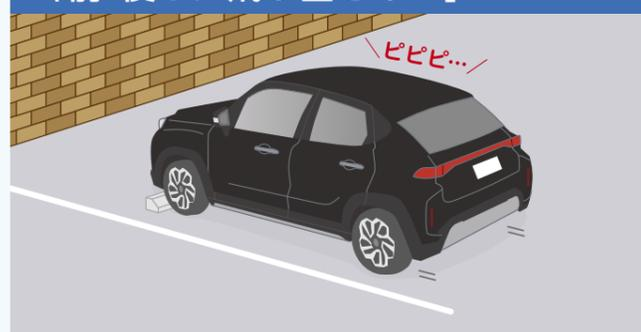
エンジン出力を抑えて、ペダルやシフトの操作ミスによる衝突の回避に貢献します。
