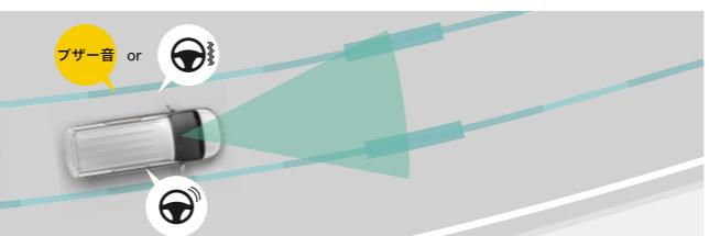
車線から逸脱するおそれがある場合<sup>\*</sup>にディスプレイへの表示および警報ブザーまたはステアリングの振動によって知らせると同時に、ステアリング操作を支援。歩行者や駐車車両を避けるための意図的な車線逸脱と判断した場合は、警報機能の作動を抑えます。
