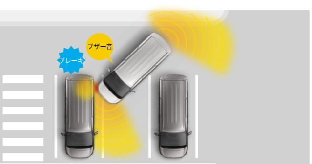
駐車時のアクセルの踏みまちがいや踏みすぎなどで起こる衝突を緩和。出庫や後退操作中に周囲を監視しながら静止物の接近を表示とブザーで知らせ、さらに距離が縮まると衝突被害軽減ブレーキをかけます。
