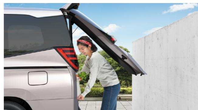
手動でバックドア開閉時に途中停止して保持する機能。クルマの後方が狭くても安心して荷物の積み降ろしができます。開度調整機構により、ドアの位置をキープ。一度保持した後は、閉方向のみ動作する機構です。
