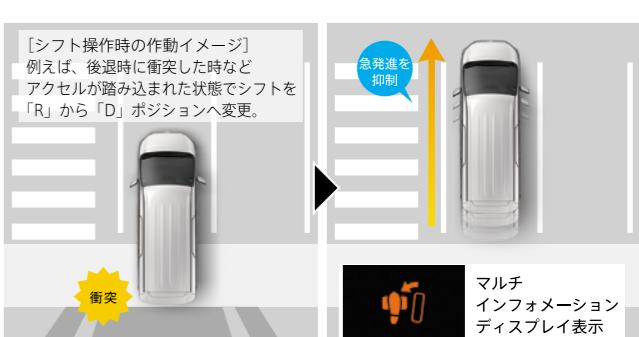
シフト操作時の急発進・急加速を抑制。後退時に衝突して慌てたドライバーが、アクセルを踏み込んだままシフトを「R」から「D」へ変更した際、表示で注意喚起し、エンジン出力/ハイブリッドシステム出力を抑制。後退時に必要以上にアクセルを踏んだ場合も同様に出力を抑制します。
