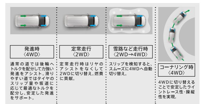
通常の道では後輪へトルクを分配して力強い発進をアシスト。滑りやすい道ではタイヤのスリップ量や路面に応じて最適なトルクを配分し、安定した発進をサポート。
