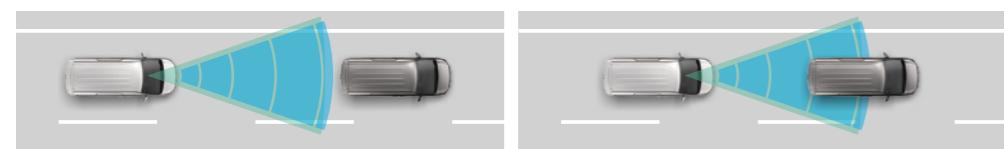
ミリ波レーダーと単眼カメラで先行車を認識し、車速に応じた車間距離を保ちながら追従走行を支援。高速道路での渋滞やノロノロ運転時も快適にサポートします。
