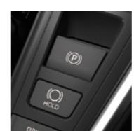
シフトレバーを「P」ポジションに入れると自動で作動。ブレーキペダルを踏みながら「D」ポジションなど「P」ポジション以外にシフトすると解除されるオートモードが付いています。
