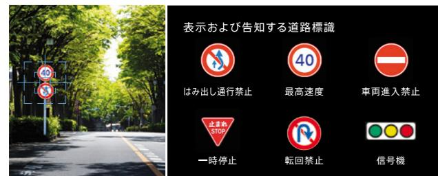
単眼カメラで認識した「最高速度/はみ出し通行禁止/一時停止/転回禁止」の道路標識をディスプレイ表示。また、「最高速度/車両進入禁止/赤信号」の道路標識や信号に従っていないとシステムが判断した場合、表示の反転や点滅、ブザーなどでドライバーに告知します。
