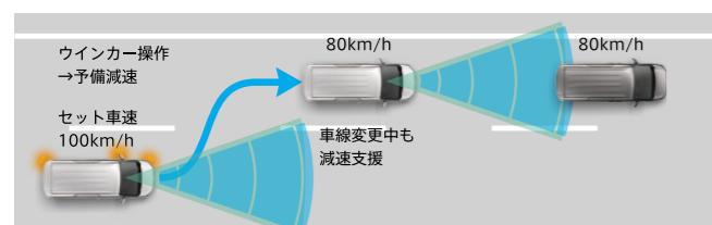
高速域での走行中に追い越し車線へ車線変更する場合、遅い先行車を追い越すための予備加速、または車線変更先の遅い先行車に追従するための予備減速を実施し、スムーズな追い越しや車線変更を支援します。
