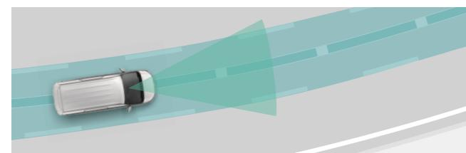
レーダークルーズコントロール[全車速追従機能付]作動時、車線維持に必要なステアリング操作支援を行ないます。車線が見えにくい場合でも先行車を追従して操作を支援。隣接車線の車両を追い抜く場合などは、走行している車線の中央よりも回避側に走行位置を調整し、安全運転を支援します。
