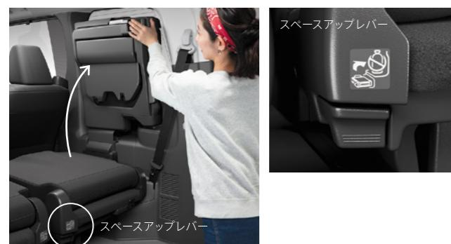
サードシートはワンタッチで折りたたんで簡単にロックが可能。格納時はスリムに収まり、広い荷室を確保できます。車内に乗り込まずに操作できるため、ラクにスペースを拡大できます。
