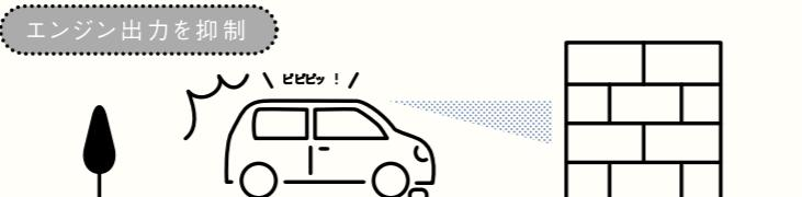
駐車場などで、前方に壁などがあるにも関わらずシフトをD・L(Sモード含む)の位置でアクセルペダルを強く踏み込むと、最長約5秒間、エンジン出力を自動的に抑制。急発進・急加速を抑えて、踏みまちがいなどによる衝突回避に貢献します。
