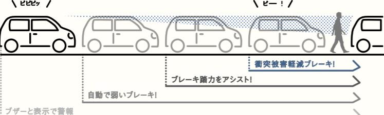
前方の車両や歩行者を検知し、衝突のおそれがあればブザー音や表示によって警告します。衝突の可能性が高まると自動で弱いブレーキを作動。その間ブレーキペダルを踏むとブレーキ踏力をアシスト。さらに衝突の可能性が高まると、自動で強いブレーキをかけ、衝突の回避または衝突時の被害軽減を図ります。
