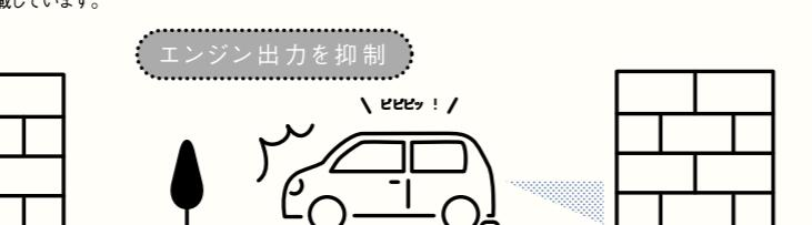
リヤバンパー内蔵した4つの超音波センサーで後方の障害物との距離を測り、4段階のブザー音とメーター表示で障害物の接近をお知らせする「リバーキングセンサー」を搭載。また、後方の障害物との衝突の可能性が高まると、衝突被害軽減ブレーキが作動し、衝突の回避または衝突時の被害軽減を図る「後退時ブレーキサポート」も搭載しています。
