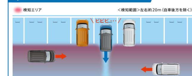
駐車場などで後退しているとき、自車の後方左右から接近する車両を検知。メーター内の表示および、インジケータの点滅とブザー音によりドライバーに注意を促します。
