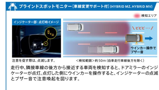
〈作動条件〉約15km/h以上で走行中、隣接車線の後方より接近する車両を検知した場合。
