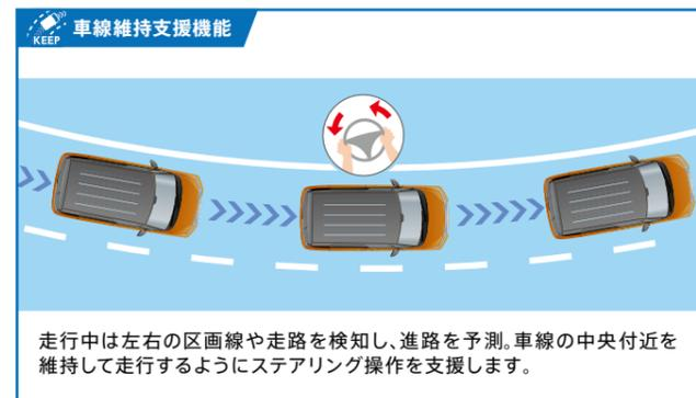
〈作動条件〉機能をONの状態であダプティブクルーズコントロールの作動中に車線または先行車(二輪車除く)を検知している場合。
