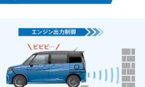
システムが進行方向の障害物を検知。停車または徐行中で作動。アクセルペダルを強く踏み込むと、エンジン出力を自動的に抑制します。作動中はブザー音を鳴らし、メーター内の表示灯を点滅させてエンジン出力の抑制をお知らせします。
