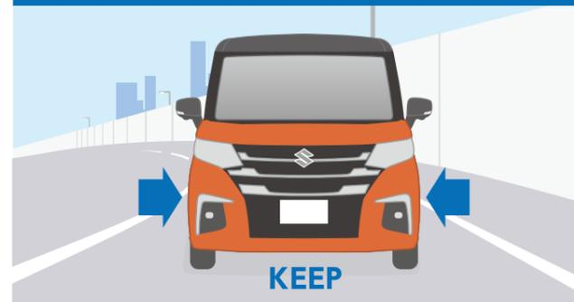
高速道路や自動車専用道路を走行中、車線の中央付近を維持するようにステアリング操作を支援。運転操作の負担を軽減します。
