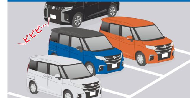
駐車場での後退時、後方左右より接近するクルマを検知。駐車場から後方発進をサポートします。
