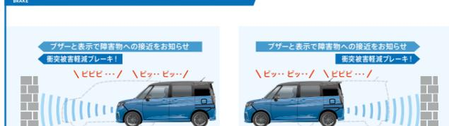
フロントとリアバンパーに内蔵した各4つの超音波センサーで、前方・後方の障害物との距離を測り、4段階のブザー音とメーター表示で障害物への接近をお知らせする「パーキングセンサー」を搭載し、さらに、前方・後方の障害物との衝突の危険性が高まると衝突被害軽減ブレーキが作動し、衝突の回避または衝突時の被害軽減を図ります。
