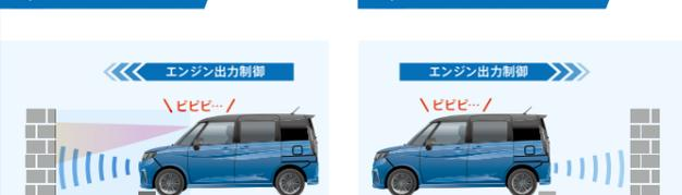
システムが進行方向の障害物を検知。停車または徐行中で作動。アクセルペダルを強く踏み込むと、エンジン出力を自動的に抑制します。作動中はブザー音を鳴らし、メーター内の表示灯を点滅させてエンジン出力の抑制をお知らせします。
