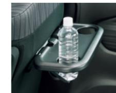
\*テーブル耐荷重2kg \*ショッピングフック耐荷重4kg(テーブル裏の2カ所は1kg)
