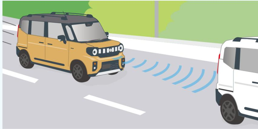
高速道路や自動車専用道路を走行中、設定した速度での走行や、適切な車間距離を保ちながら先行車を追従することで、運転操作の負担を軽減します。
