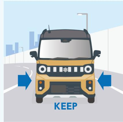
高速道路や自動車専用道路を走行中、車線の中央付近を維持するようにステアリング操作を支援。運転操作の負担を軽減します。
