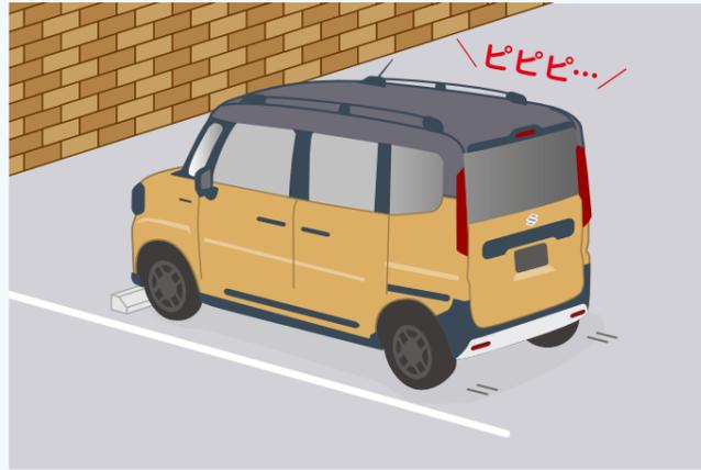
エンジン出力を抑えて、ペダルやシフトの操作ミスによる衝突の回避に貢献します。
