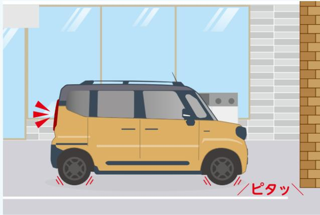
駐車時などで障害物を検知し、低速時の走行をサポートします。
