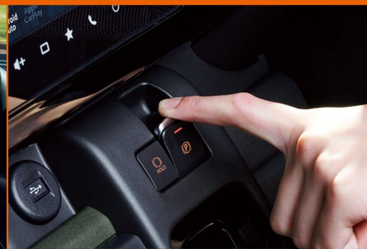
スイッチひとつで簡単操作の電動パーキングブレーキ。
