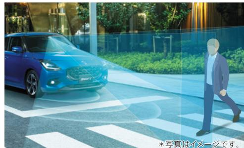
システムが衝突のおそれがあると判断すると、ブザー音やメーター内の表示によってドライバーに警告。その間ブレーキペダルを踏むと、ブレーキ踏力をアシスト。さらに、衝突の可能性が高まると、自動で強いブレーキをかけ、衝突の回避または衝突時の被害軽減を図ります。
