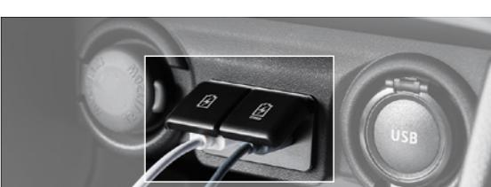
USB電源ソケット[Type-A/Type-C](インバネ2個)(HYBRID MZ)
