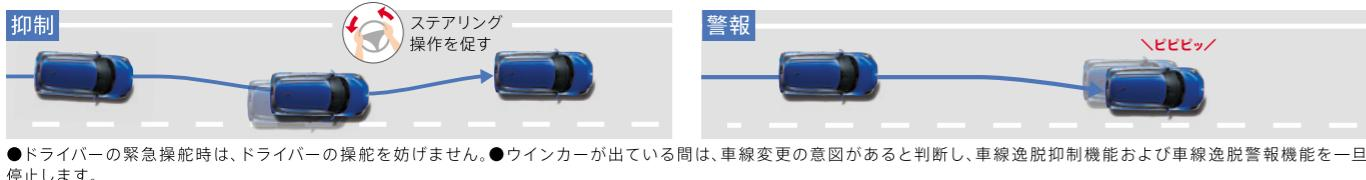
●ドライバーの緊急操舵時は、ドライバーの操舵を妨げません。●ウインカーが出ている間は、車線変更の意図があると判断し、車線逸脱抑制機能および車線逸脱警報機能を一旦停止します。
