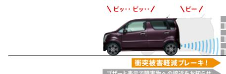
\*衝突被害軽減ブレーキ機能による車両停車後は、クリープ現象により後退しますので、必ずブレーキペダルを踏んでください。
