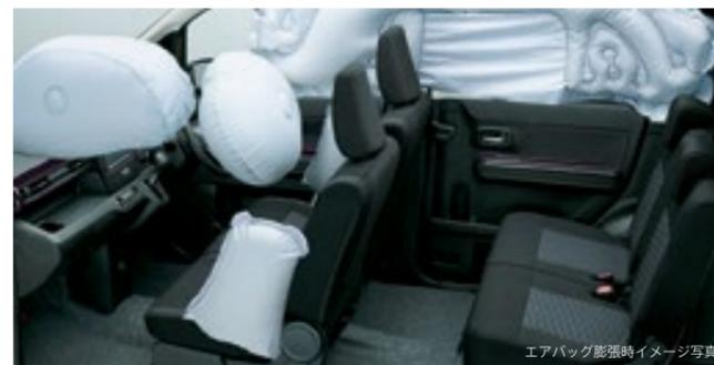
●SRSエアバッグシステムは、シートベルトを補助する装置ですので、必ずシートベルトをご着用ください。●SRSエアバッグシステムは、衝突の条件によっては作動しない場合があります。また、ご注意ください項目がありますので、必ず取扱説明書をよくお読みください。SRSカーテンエアバッグ、フロントシートSRSサイドエアバッグは、実際の衝突時には衝突側のみ膨らみます。
