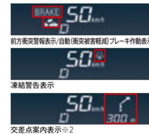
前方衝突警報表示/自動(衝突被害軽減)ブレーキ作動表示
