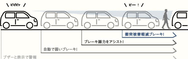
前方の車両や歩行者を検知し、衝突のおそれがあればブザー音や表示によって警告します。衝突の可能性が高まると自動で弱いブレーキを作動。その間ブレーキペダルを踏むとブレーキ踏力をアシスト。さらに衝突の可能性が高まると、自動で強いブレーキをかけ、衝突の回避または衝突時の被害軽減を図ります。
