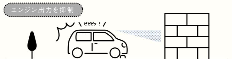
駐車場などで、前方に壁などがあるにも関わらずシフトをD・L(Sモード含む)の位置でアクセルペダルを強く踏み込むと、最長約5秒間、エンジン出力を自動的に抑制。急発進・急加速を抑えて、踏みまちがいなどによる衝突回避に貢献します。
