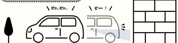
\*衝突被害軽減ブレーキ機能による車両停車後は、クリープ現象により後退しますので、必ずブレーキペダルを踏んでください。
