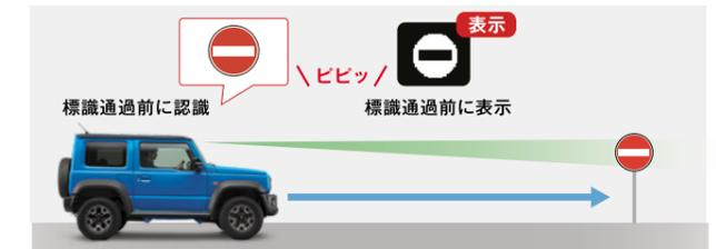
走行中に、単眼カメラが認識した“車両進入禁止”の標識を標識通過前にブザー音とメーター内表示で、ドライバーにお知らせします。
