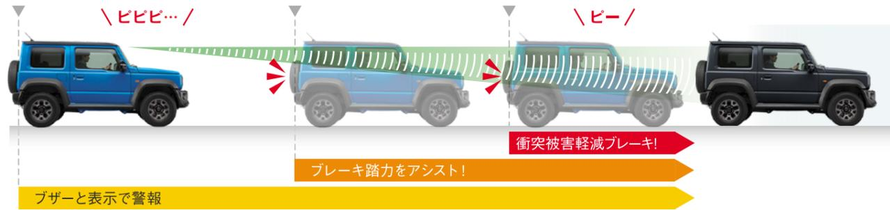
⚠️ 自車速度約5km/h～約100km/h(対象が歩行者の場合は約5km/h～約60km/h)で走行中、前方の車両や歩行者を検知し、システムが衝突の可能性があると判断した場合、作動した時の速度が約5km/h～約50km/h(歩行者の場合は約5km/h～約30km/h)であれば、衝突を回避できる場合があります。周囲の環境や対象物の動きなどによっては、警報のみでブレーキが作動しない場合があります。また、警報と同時に衝突被害軽減ブレーキが作動する場合があります。
