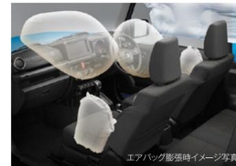
●SRSエアバッグシステムは、シートベルトを補助する装置ですので、必ずシートベルトを着用してください。●SRSエアバッグシステムは、衝突の条件によっては作動しない場合があります。また、ご注意ください項目がありますので、必ず取扱説明書をよくお読みください。SRSカーテンエアバッグ、フロントシートSRSサイドエアバッグは、実際の衝突時には衝突側のみ膨らみます。
