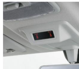
\*助手席や後席に荷物などを載せると、荷物の重さや形状によってはシートベルトリマインダーが作動して、警告音とインジケータの警告ランプが点灯する場合があります。
