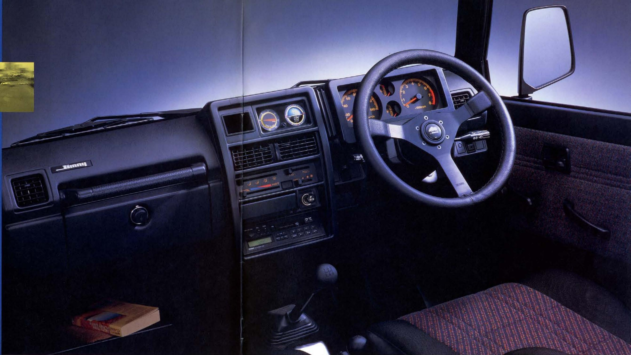
Photo: ハンHC (MOMO製革巻ステアリングホイール、傾斜計&高度計、電子チューニング式AM/FMラジオ付カセットステレオはオプション)
