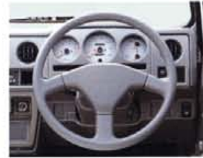
3本スポークウレステアリングホイール (全車)* 太い握りに手になじり運転が楽。*運転席SRSエアバッグ&4輪ABS装着車は4本スポークウレステアリングホイールとなります。
