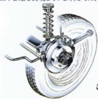
FRONT SUSPENSION 3リンク(リーディング+ラテラルロッド)リジッド式コイルスプリング
