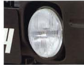
ハロゲンフォグランプ (XC, XL) 霧や夜間の走行中、路面を明るく照らすフォグランプをバンパーに内蔵しました。
