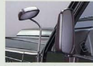
ドアミラー&サイドアンダーミラー (全車) 大型のドアミラーに加え、助手席側下方の視界を確保するサイドアンダーミラーを装備しました。
