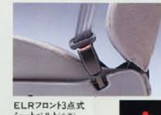
ELRフロント3点式シートベルト (全車) 体にフィットするベルトインシートやシートベルトの着用を促す警告灯も装備。
