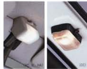
3ポジションルームランプ (全車) スイッチによるON/OFF、ドアの開閉に連動して点灯・消灯する3ポジションタイプ。
