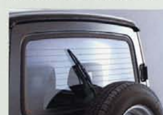
熱線入りバックウインドーガラス (XC, XL, HA) リヤワイパー&ウォッシャー (XC, XL) ウインドーの曇りや汚れを除き後方視界を確保します。
