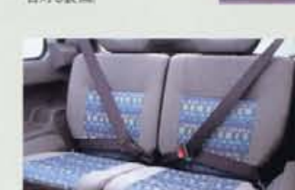
ELRリヤ3点式シートベルト (XC, XL) 乗用車仕様には、後席の乗員のためのリヤ3点式シートベルトを標準装備しています。
