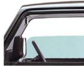
熱線吸収グリーンガラス (全車) 紫外線の吸収効果にも優れた熱線吸収グリーンガラス。夏の強い日差しをやわらけます。
