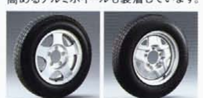
175/80R16ラジアルタイヤ & アルミホイール(XL) 175/80R16ラジアルタイヤ(XC, CC)
