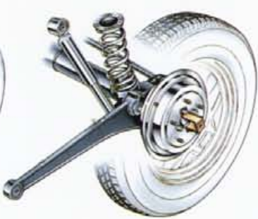
REAR SUSPENSION 3リンク(トレーリング+ラテラルロッド)リジッド式コイルスプリング
