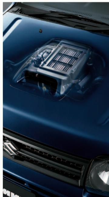
ハイパワーと粘り強いトルクを発生させるDOHCインタークーラーターボエンジンを全車に搭載。大型のインタークーラー採用に加えカムプロファイル及びエキゾーストマニホールドの形状に徹底的にこだわりました。さらに、シリンダーヘッドを改良することで、従来より厚みのある中低速トルクを発揮。高速道路では低速から高速までスムーズに加速し、ストップ&ゴーの多い街中でもアクセルレスポンスの向上により快適な走行を実現しました。また、吸・排気系のレイアウトを適正に配置し、車内への振動や騒音を低減。オールアルミ製エンジンやラジエーターは、車両の軽量化に加え、リサイクルしやすいため、環境保護にも貢献しています。
