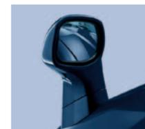
**電動格納式リモコンカラードアミラー<sup>(XC)</sup>**
