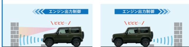
システムが進行方向の障害物を検知。停車または徐行中で作動。アクセルペダルを強く踏み込むと、エンジン出力を自動的に抑制します。作動中はブザー音を鳴らし、メーター内の表示灯を点滅させてエンジン出力の抑制をお知らせします。
