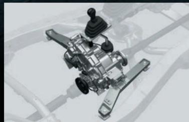
路面状況に応じて2WD⇄4WDを切り替えることができる機械式の副変速機。トランスファーレバーのダイレクトな操作感が、走りに向かうドライバーの気持ちを高めます。
