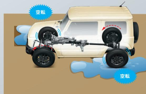
右前輪と左後輪が空転した場合、左前輪と右後輪の駆動力が失われてしまいます。
