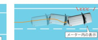
長時間の走行中、左右の区画線を検知し、自車の走行パターンを計測。「ふらつき」とシステムが判断した場合、ブザー音とメーター内の表示で警報。
