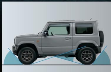
エンジンをフロントタイヤ前端より後方に配置したFRレイアウト。険しい凹凸を越えていくために必要なアプローチアングルを確保する、本格4WDの原点です。
