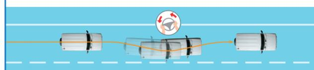
走行中は、左右の区画線や走路を検知し進路を予測。車線逸脱の可能性が高いとシステムが判断すると、ステアリングに力を加えることでドライバーに操作を促し、車両を車線の内側に戻すよう支援。
