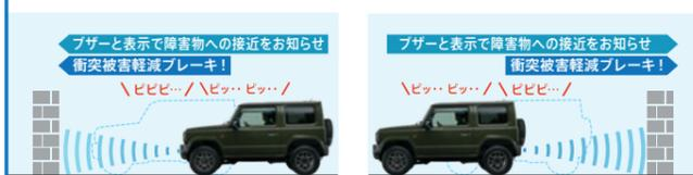
フロントとリアバンパーに内蔵した各4つの超音波センサーで、前方・後方の障害物との距離を測り、4段階のブザー音とメーター表示で障害物への接近をお知らせする「パーキングセンサー」を搭載し、さらに、前方・後方の障害物との衝突の危険性が高まる時衝突被害軽減ブレーキが作動し、衝突の回避または衝突時の被害軽減を図ります。
