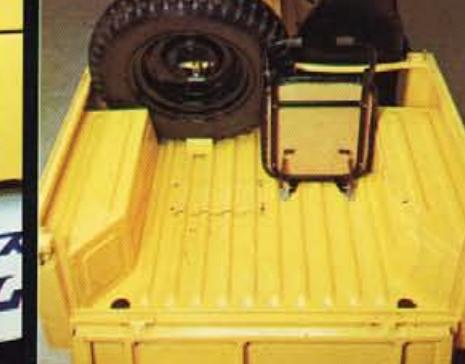
●250kg積める荷台と折りたたみ式の補助シート。
