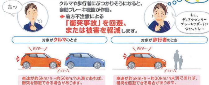
前方衝突被害軽減ブレーキアシスト機能、自動ブレーキ機能をはじめ、車線逸脱警報機能、ハイビームアシスト機能などの先進の安全技術の搭載を可能にしました。さらにスイフトスポーツは、スズキ初となる車線逸脱抑制機能を採用。安全装備の充実を図っています。
