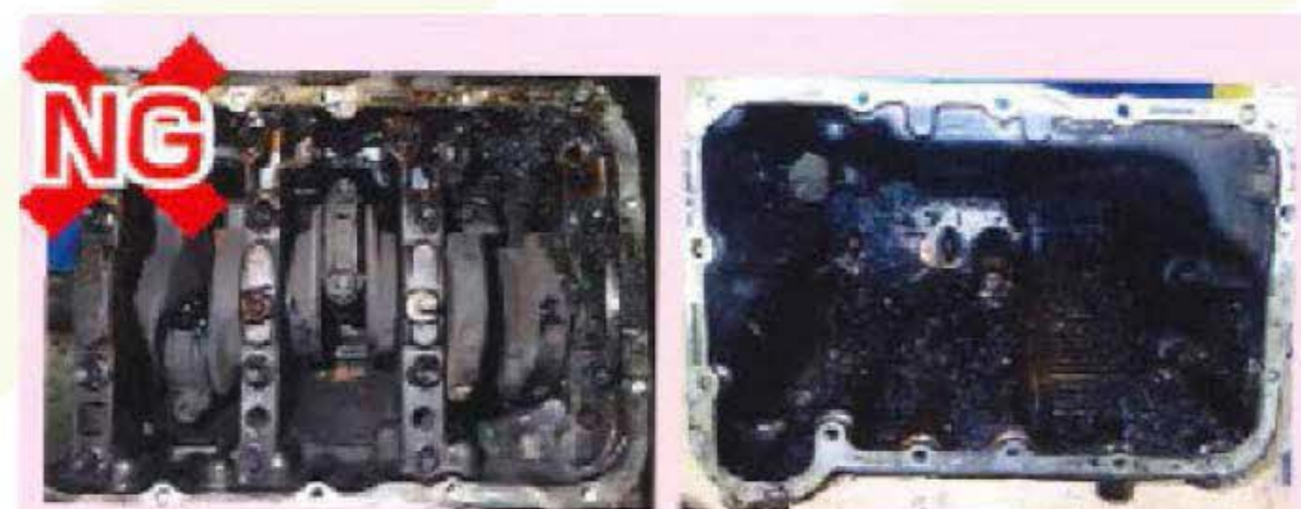
オイル交換のメンテナンスを怠ったエンジン内部
