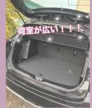
5名乗車時で最大 430 Lの大容量!! リアシートを倒せばスペースはさらに拡大。 自転車やゴルフバック、 スノーボードなどの 長い荷物を載せること もできます♪
