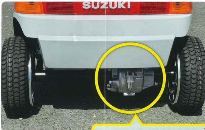
シート下の車体下部に、オイル漏れや異常なサビ、ボルトの欠損等の損傷がないか確認してください。
