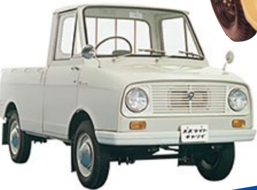
1961年 ＜スズライトキャリイFB＞ 先進的な設計により機能を追求した本格的軽四輪トラック。 (2サイクル2気筒360cc)
