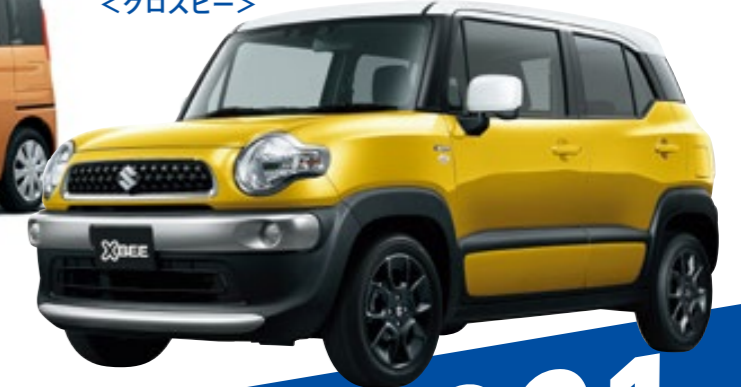
2017年 ＜クロスビー＞ 全車に1000cc直噴ターボエンジンとマイルドハイブリッドを組み合わせたほか6速ATを採用。
