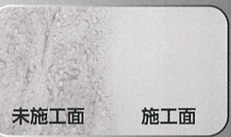
※人工汚れとしてスス、火山灰、水の混合物を吹付た後、乾燥させ流水にて洗浄
