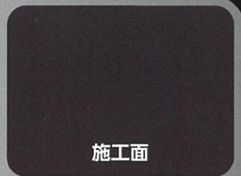
※ウォッシャビリティ試験機でクロスに500gの荷重をかけ20回往復させた後の傷の状態
