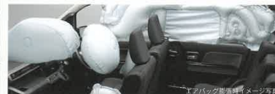
■フロントシートSRSサイドエアバッグ&SRSカーテンエアバッグ ●SRSエアバッグシステムは、シートベルトを補助する装置ですので、必ずシートベルトをご着用ください。●SRSエアバッグシステムは、衝突の条件によっては作動しない場合があります。また、ご注意ください項目がありますので、必ず取扱説明書をよくお読みください。SRSカーテンエアバッグ、フロントシートSRSサイドエアバッグは、実際の衝突時には衝突側のみ膨らみます。*SRS-Supplemental Restraint System(補助拘束装置)
