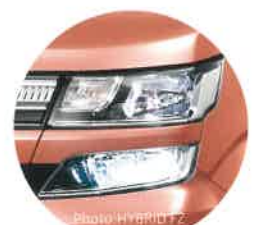
LEDヘッドランプ [ロービーム、オートレベリング機構付] (HYBRID FZ)
