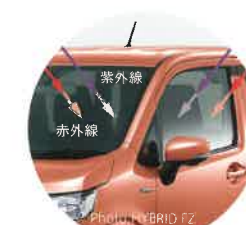
プレミアムUV&IRカットガラス(フロントドア)/ IRカット機能付フロントガラス(HYBRID FZ) UVカット率:フロントガラスとフロントドアガラスは約99%
