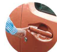
リクエストスイッチ キーレスプッシュスタートシステム (HYBRID FZ, HYBRID FX セーフティパッケージ装着車※2)
